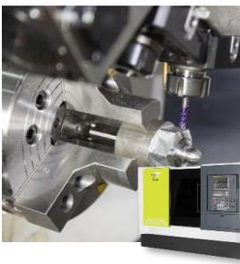
五軸複合式車削中心機
