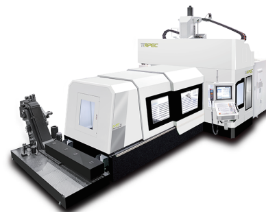
五軸定柱式龍門加工中心機
