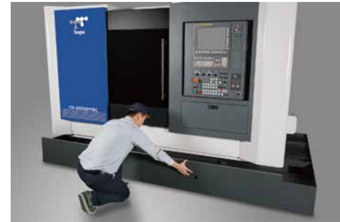
前拉式水槽可直接由機台前方拉出，此設計可減少佔地面積與提升保養便利性。
